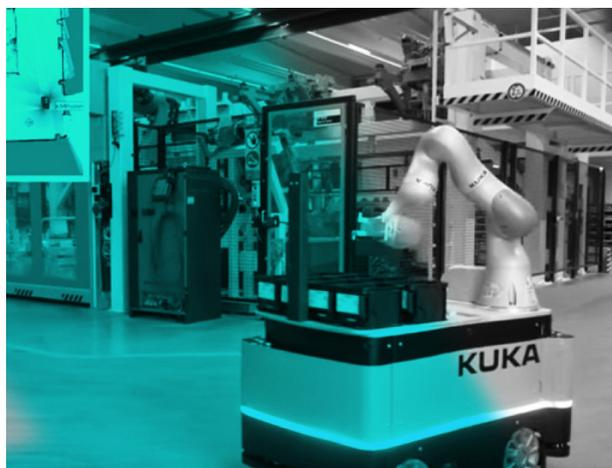
AGV con cobot de Kuka
