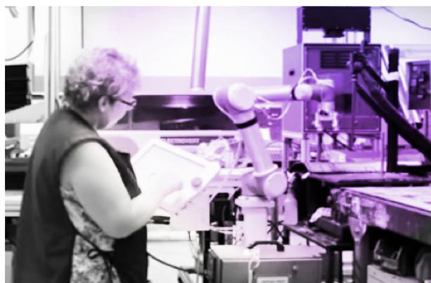
Operaria programando cobot sobre ruedas para descarga de línea
